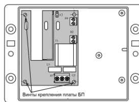
Рис.2 – Схема монтажа БП/ВКТ-7 в корпусе вычислителя
